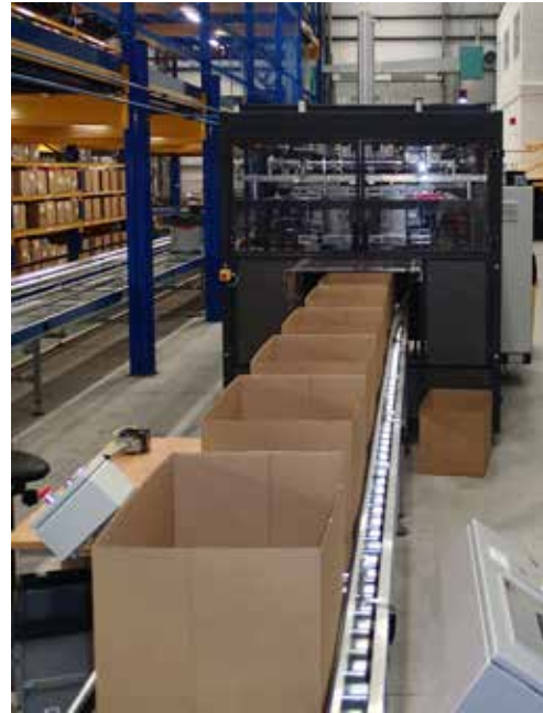
Sortie des barquettes sur système de convoiement pour la préparation de commandes
